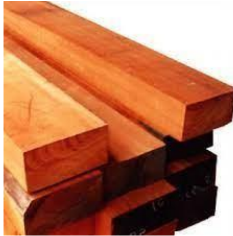
Figura 6: Caibros para compor cobertura.
