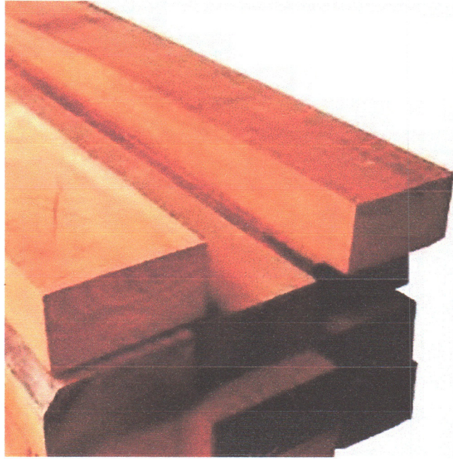
Figura 6: Caibros para compor cobertura.
